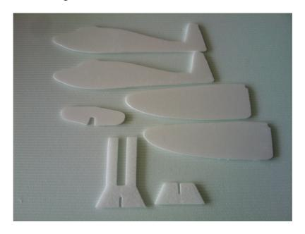
Die Teile des Flugzeugs. Zwei Tragflächen, zwei Rumpfteile und ein Höhenleitwerk. Und eine Waage zum auswiegen des Modells
